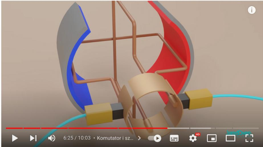
**Jak działa silnik elektryczny? (Silnik prądu stałego)**
